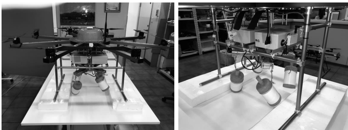
図 10 ドローンに取り付けられた保持・投下装置と 4 つの浮子の様子
