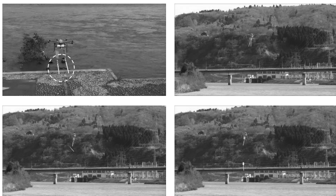
図 11 2 本の浮子を搭載した投下試験
